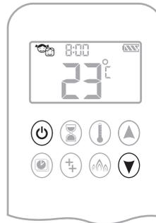
**EIN:** Drücken Sie gleichzeitig die Tasten ☺ und ☹ um die Kindersicherung zu aktivieren. ☹ wird angezeigt und die Fernbedienung ist nun funktionsunfähig (ausgenommen der AUS-Funktion).
